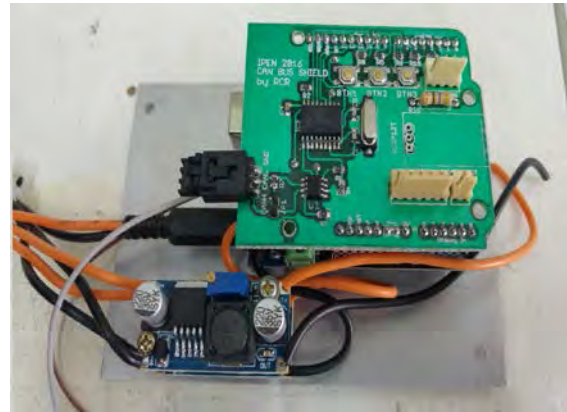
Figura 3. Nodo esclavo Arduino UNO con el shield de bus CAN.
