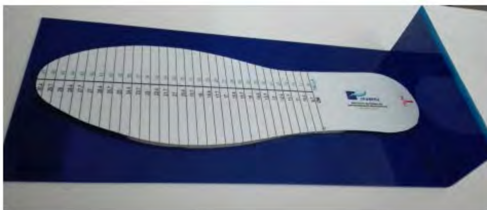
Figura 1. Dispositivo para medición de talla del pie, en cm.
