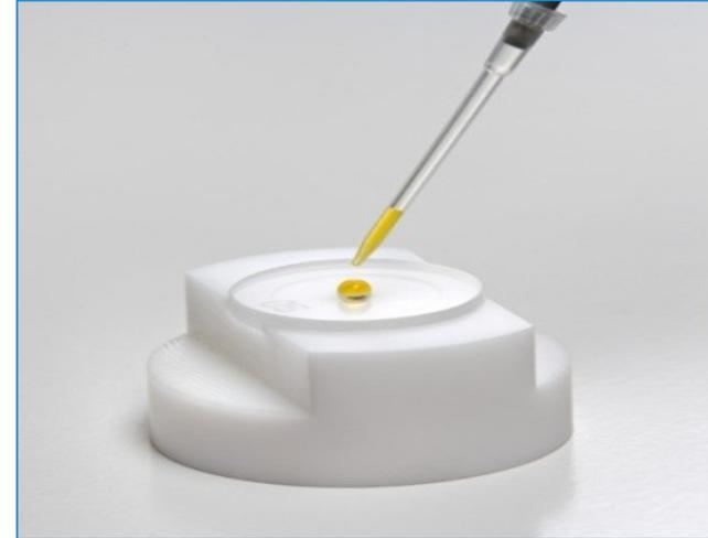
La conversión de las intensidades medidas en concentraciones es uno de los pasos más importantes en la XRF analítica. En el caso especial de TXRF, las complicaciones se eliminan por completo, ya que se puede aplicar el enfoque de película delgada, lo que conduce a una relación simple y lineal entre la intensidad,  $I$ , y la concentración,  $C$ , del elemento considerado.
