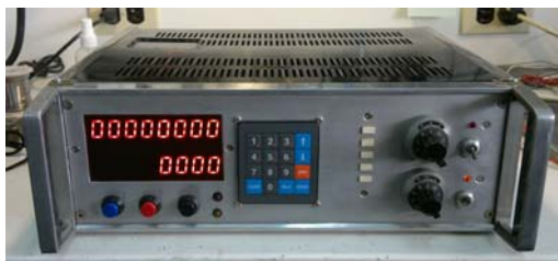
Figura 9. Vista del panel frontal modificado para incluir las actualizaciones de hardware.
