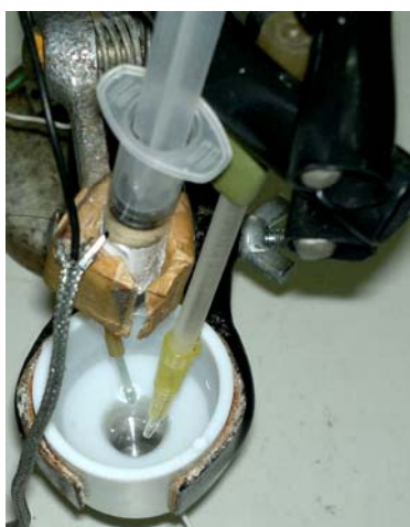
Figura 2. Celda electroquímica construida para realizar las pruebas de medición del potencióstato.
