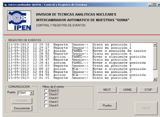
Figura 5. Captura de pantalla del programa de comunicación con la PC.
