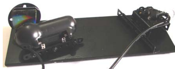
Figura 1. Placa de aluminio conteniendo los tres componentes del espectrómetro.
