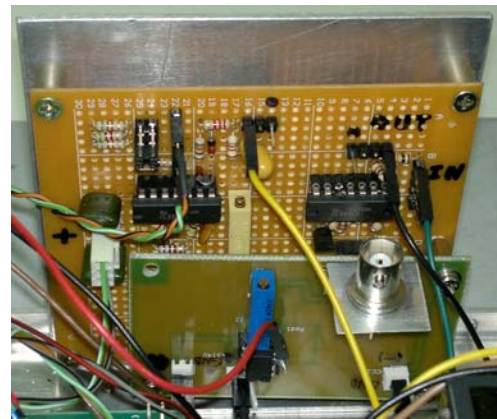
Figura 3. Imagen de los circuitos de tratamiento analógico para medición de parámetros físicos: pH, conductividad y temperatura.
