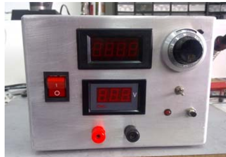
Figura 5. Primer plano del panel frontal del gabinete del galvanostato que ha sido construido.
