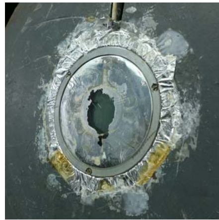
Figura 3. Recubrimiento metálico reflectivo dañado sobre el plástico centellador de uno de los detectores del cabezal de detección.
