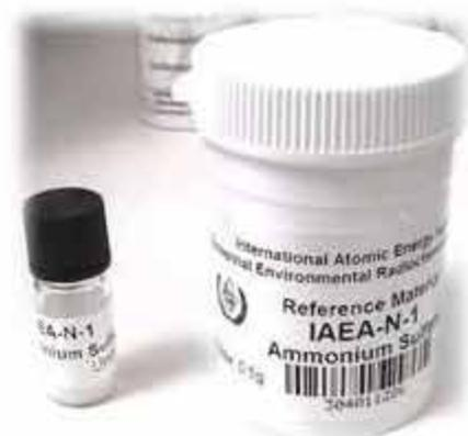
El material de referencia IAEA-N-1 está destinado a calibraciones de  $\delta^{15}\text{N}$ .
